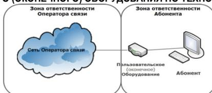
**СХЕМА ВКЛЮЧЕНИЯ ПОЛЬЗОВАТЕЛЬСКОГО (ОКОНЕЧНОГО) ОБОРУДОВАНИЯ ПО ТЕХНОЛОГИИ xPON**
